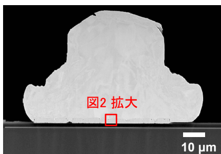
図1 ワイヤボンディング断面(二次電子像)
