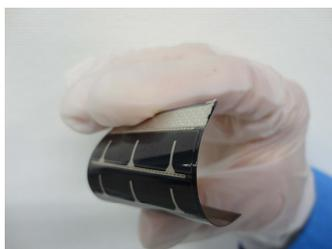
図1 フレキシブル薄膜Si太陽電池
