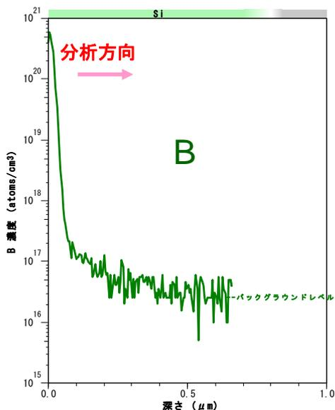
図3 a-Si中Bのデプスプロファイル
