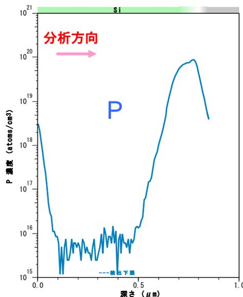
図4 a-Si中Pのデプスプロファイル
