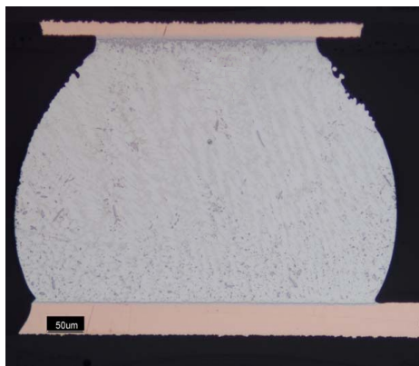
図3-a. BGA断面写真
