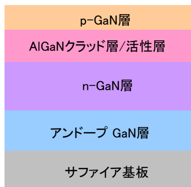
図1 試料構造模式図
