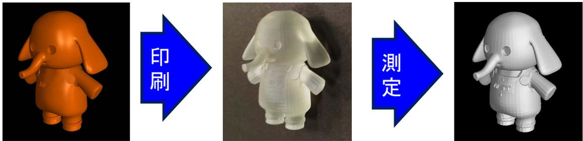
図1: 三次元の出来栄評価のフロー
