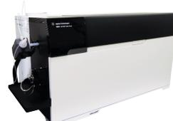
分解溶液を装置に導入し、金属元素(Li~Bi)の測定を行いました。
