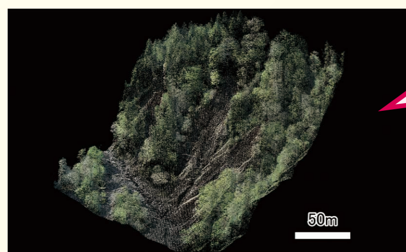
崖全体の航空LiDAR点群データ (データ提供：山梨県知事政策局)
